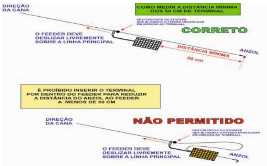
Figura 1 e 2. Montagem correta, com explicação do modo de medição do terminal
